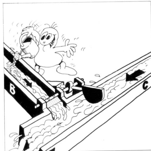
Bild 61. „Wasser-Transistor“ (leitender Zustand)
